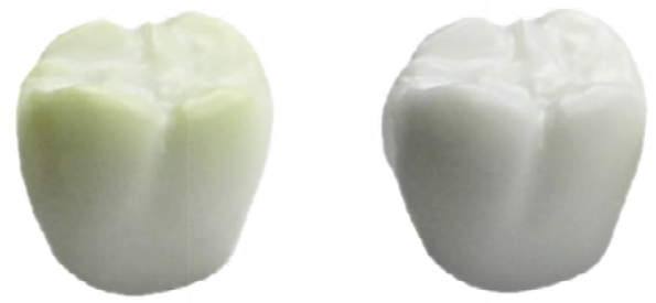
Fig. 3 : couronne gauche : décoloration jaune verdâtre due à la contamination par le \text{MoO}_3 («pestoxidation»)
