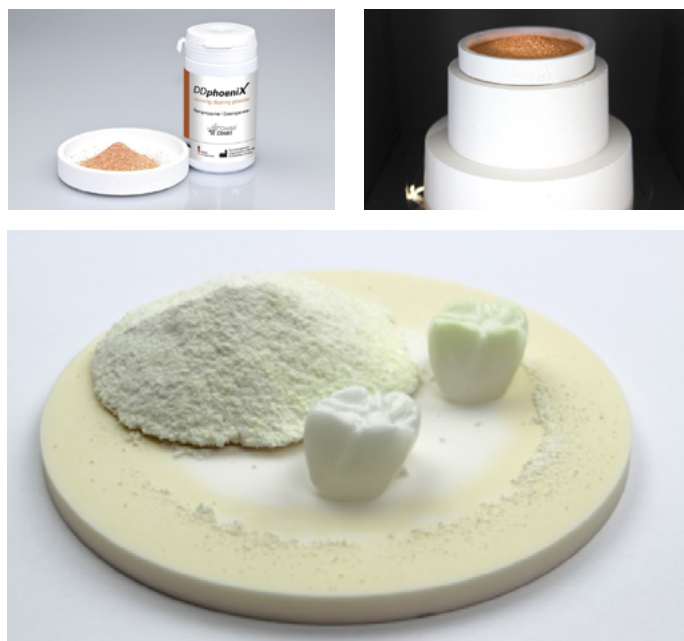
Fig. 5 : DD phoenix avant et après le frittage
