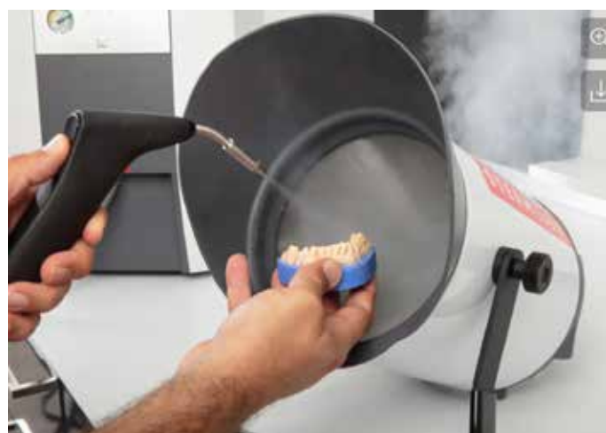
TUBE STEAM (VON RENFERT) Dampfreinigungsstation
